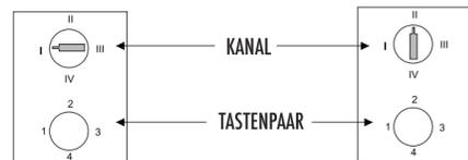
Die dritten 4 Steckdoseneempfänger auf Kanal 3 und die vierten 4 Steckdoseneempfänger auf Kanal 4.
