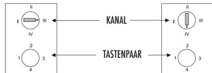
Der Schiebeshalter der Funk-Fernbedienung muss dann jeweils auf den richtigen Kanal gestellt werden. Kanal 1 für die 4 Steckdoseneempfänger mit Kanal 1 usw.
